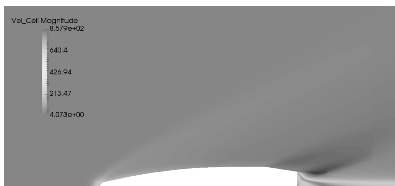
Рис. 3. Поле скоростей при обтекании пули 7Н6 со скоростью 801 м/с
