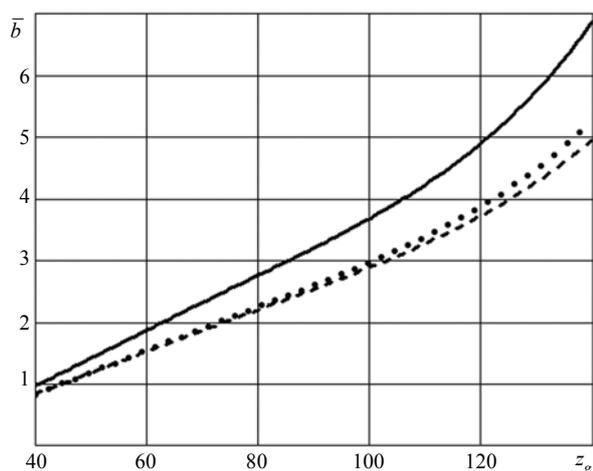
Рис. 2. Зависимость отношения ширины зубчатого венца сателлита к длине его площадки контакта с роликом от числа зубьев сателлита: ————  $\Delta z = 1$ ; .....  $\Delta z = 2$ ; - - - - -  $\Delta z = 3$
