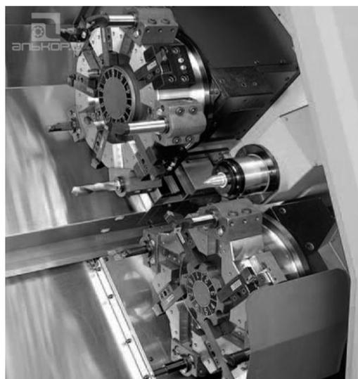
Рис. 1. Рабочая зона станка с двумя револьверными головками
