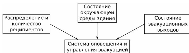
Рис. 3. Необходимые входы системы оповещения и управления эвакуацией
