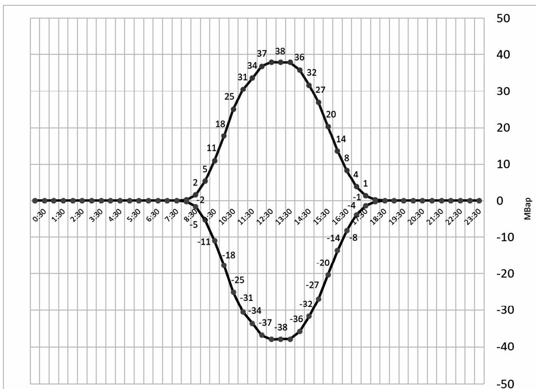
Рис. 3. Суммарный регулировочный диапазон реактивной мощности СЭС энергосистемы Крыма в зимний сезон (верхний и нижний предел)
