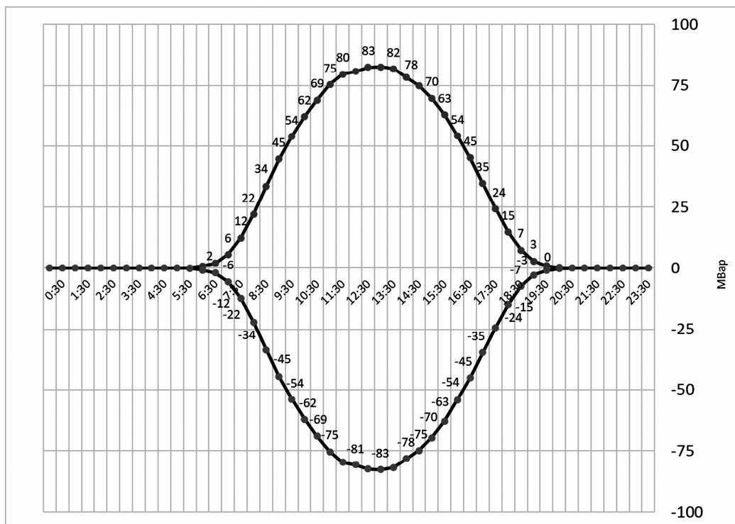
Рис. 2. Суммарный регулировочный диапазон реактивной мощности СЭС энергосистемы Крыма в летний сезон (верхний и нижний предел)
