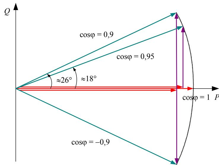
Рис. 4. Векторная диаграмма мощности СЭС
