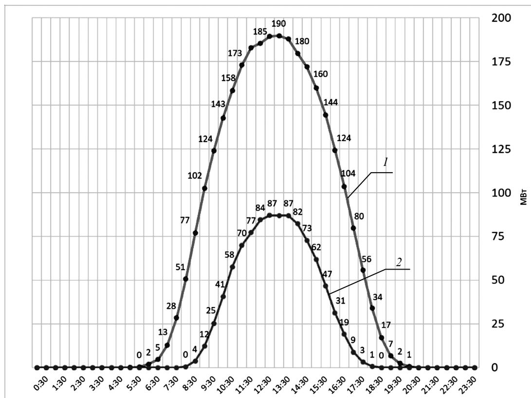
Рис. 1. Графики суточной генерации СЭС для характерных сезонов года: 1 – летний сезон; 2 – зимний сезон
