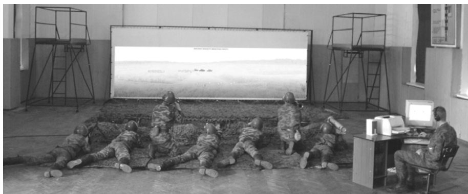
Внешний вид разработанного авторами и принятого на вооружение оптико-электронного тренажера 1У33 стрелкового оружия, гранатометов и огнеметов
