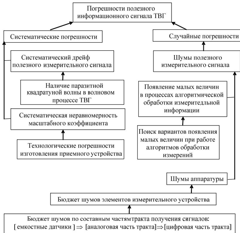
Рис. 1. Составные части погрешностей полезного измерительного устройства ТВГ и влияющие на них факторы
