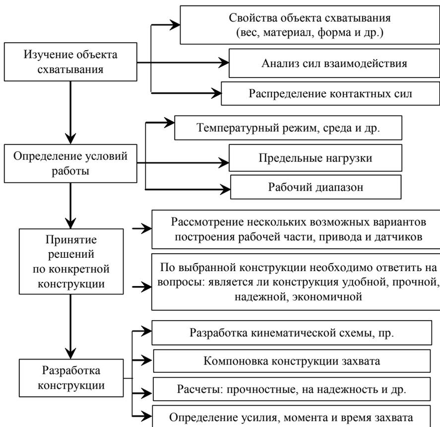
Рис. 3. Схема проектирования микрозахватов
