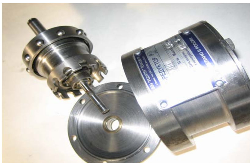
Рис. 2. Шаровой редуктор в разобранном виде (слева направо: спутник, крышка и корпус). Технические характеристики: масса 3,1 кг, передаточное отношение 55, крутящий момент на выходном валу 40 Н*м
