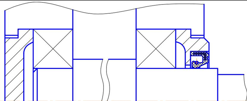
Рис. 3. Фрагмент второго варианта предлагаемой конструкции подшипникового узла
