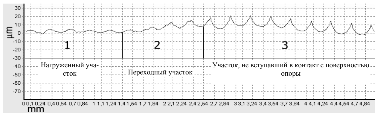
Рис. 12. Профилограмма поверхности торцевой опоры колеса после контакта с металлофторопластовой опорой скольжения
