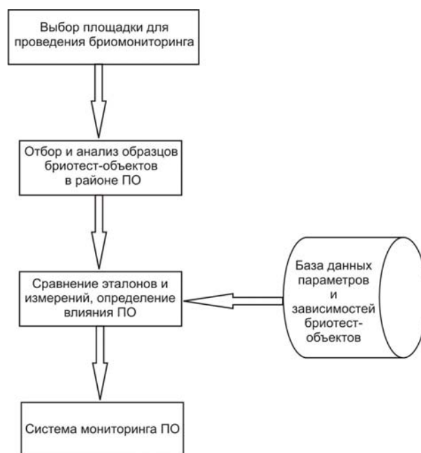
Схема проведения оперативного мониторинга с помощью бриотест-объектов
