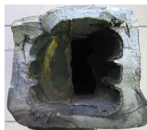
Рис. 2. Излом боковой рамы коробчатого сечения в пути следования. Сход вагона (а), усталостный излом с наличием металлургических дефектов (б)
