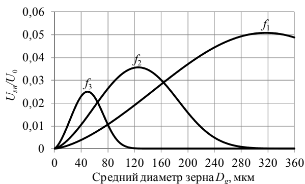
Рис. 4. Уровень структурных шумов U_{sn}/U_0 в зависимости от диаметра зерна
