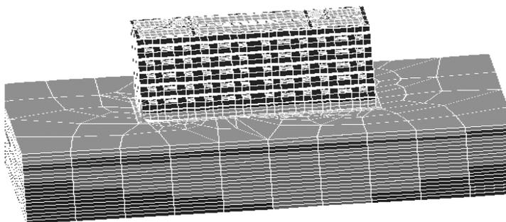
Рис. 6. Конечно-элементная модель системы ЗФО
