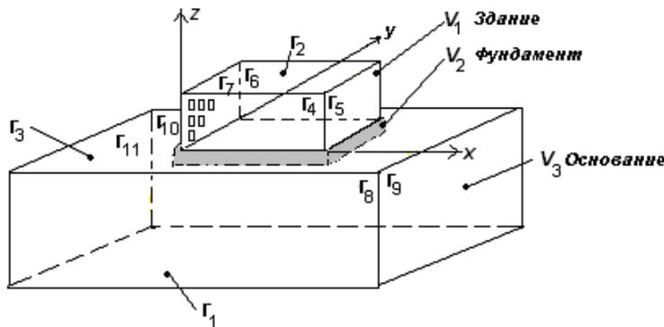
Рис. 1. Система «здание – фундамент – основание»
