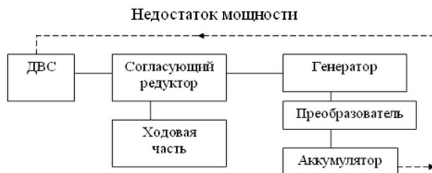
Рис. 4. Автомобиль с ГСУ параллельного типа при недостатке мощности
