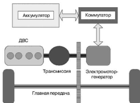
Рис. 1. Параллельная конструктивная схема ГСУ
