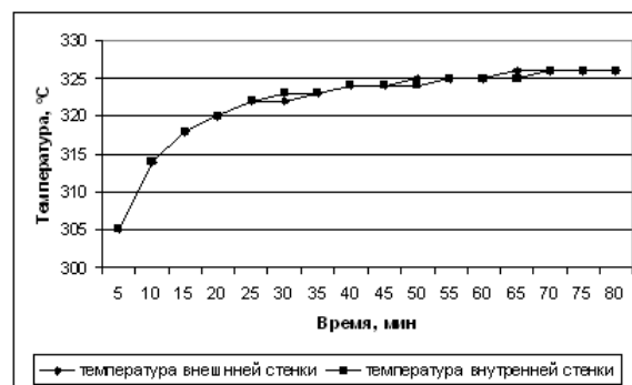
Рис. 4. Кривые изменения температуры внутренней и внешней стенок газогенератора в зоне пиролиза
