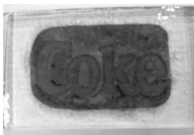
Рис. 3. Изделие из стекла, полученное фьюзингом и декорированное алюминиевыми включениями
