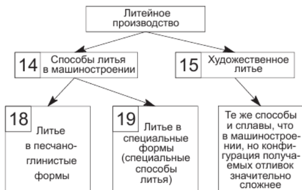
Рис. 4. Классификация способов литья
