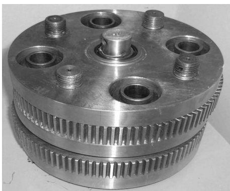
Рис. 10. Блок сателлитов экспериментального образца зубчато-роликовой планетарной передачи
