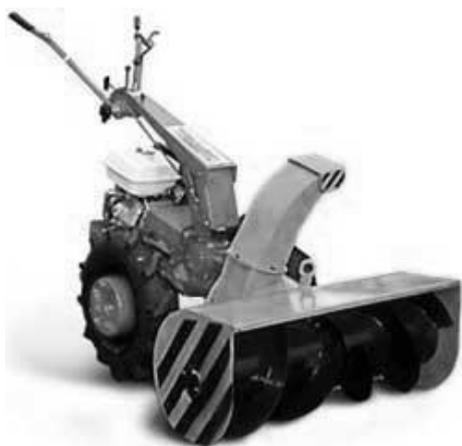
Рис. 1. Малогабаритный шнекороторный снегоочиститель СН-1М
