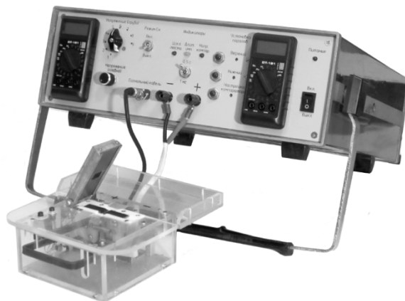
Рис. 3. Стенд для испытаний танталовых конденсаторов импульсным током
