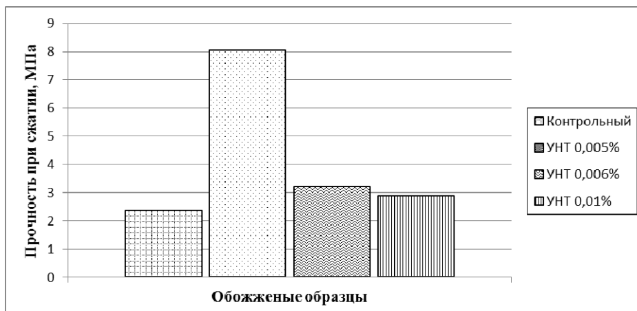
Рис. 3. Предел прочности на сжатие образцов после обжига
