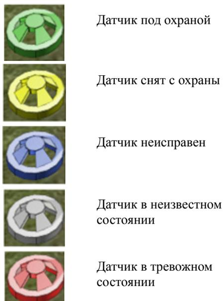
Рис. 3. Система обозначений (настройки цветовой гаммы), принятая по умолчанию (на примере пожарного датчика)
