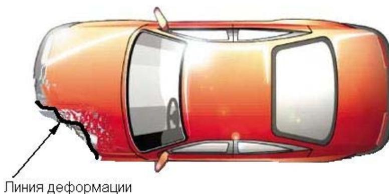
Рис. 2. Явно выраженная линия деформации кузова автомобиля
