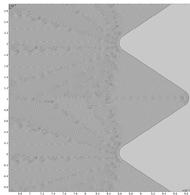
Рис. 7. Модель задачи с сеткой конечных элементов на примере одного зуба резьбы
