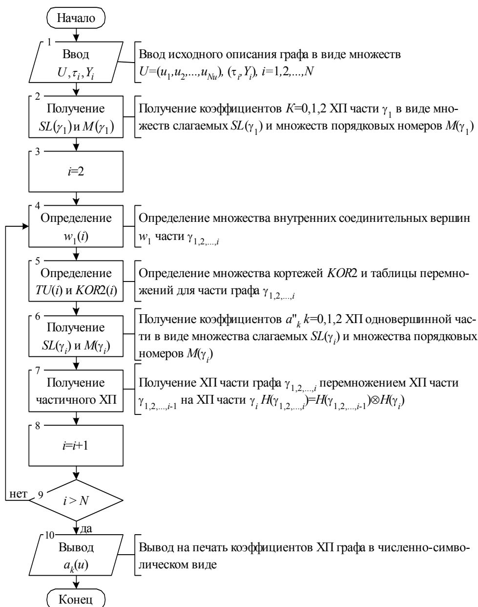
Рис. 4. Укрупненный алгоритм получения характеристического полинома системы
