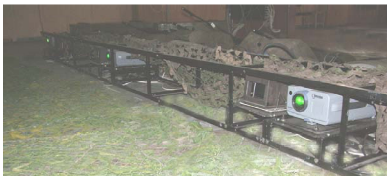
Рис. 3. Ферма с проекторами и датчиками
