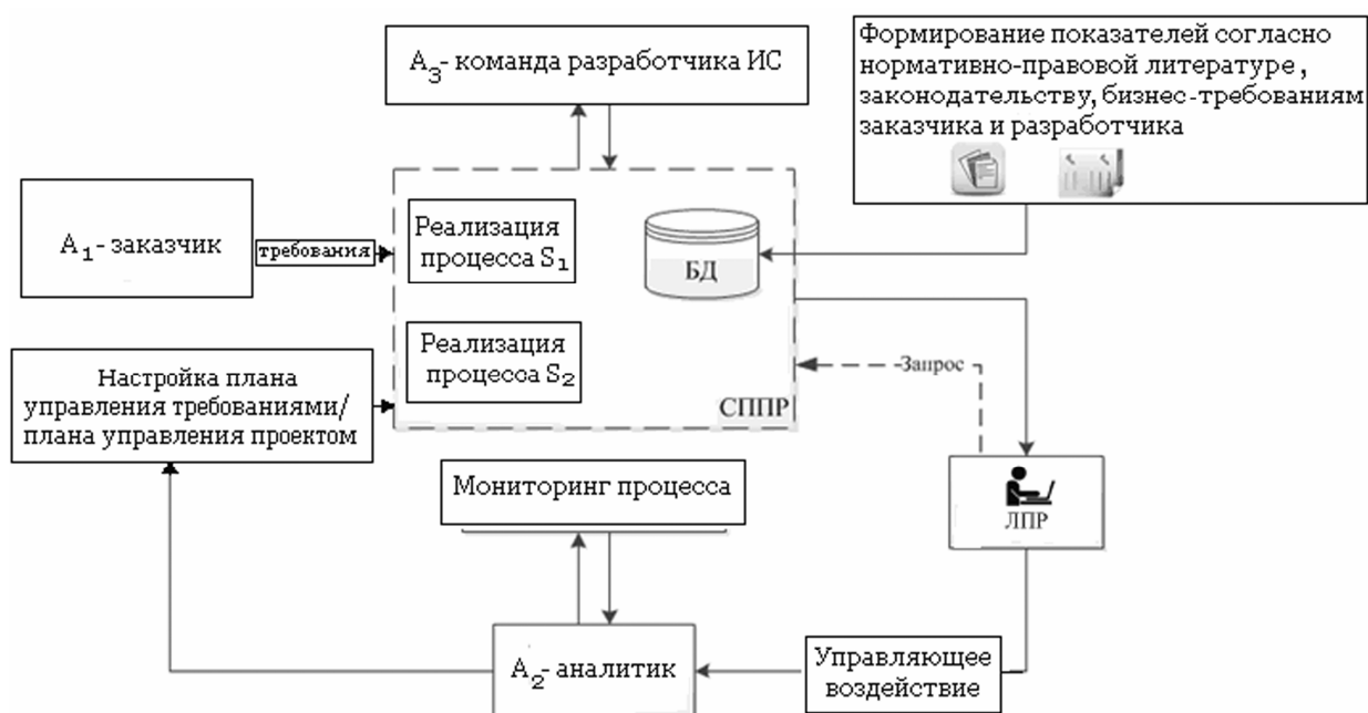
Рис. 1. Концептуальная модель управления процессами анализа требований и распределения работ при разработке информационных систем: A_1 – заказчик, A_2 – аналитик, A_3 – команда разработчика ИС, S_1 – реализация процесса анализа требований, S_2 – реализация процесса распределения работ
