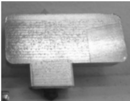
Рис. 8. Индукционный нагреватель в корпусе-радиаторе
