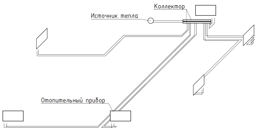
Рис. 4. Лучевая коллекторная система отопления
