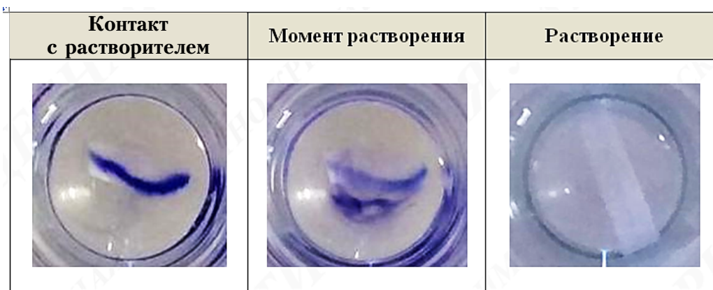
Рис. 13. Контакт исследуемого штриха с органическим растворителем -N,N-диметилформамидом
