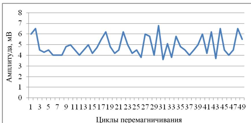
Рис. 4. Флуктуации амплитуды импульсов ЭДС на входе ИК БИСЕР-1 от цикла к циклу 50 циклов перемагничивания
