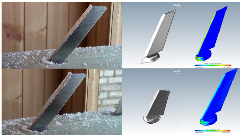
Рис. 4. Результаты моделирования процесса обледенения в программном комплексе Ansys и их сравнение с реальными экспериментами в аэрохолодильной трубе
