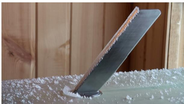
Рис. 1. Обледенение флюгера датчика в ходе натурального эксперимента
