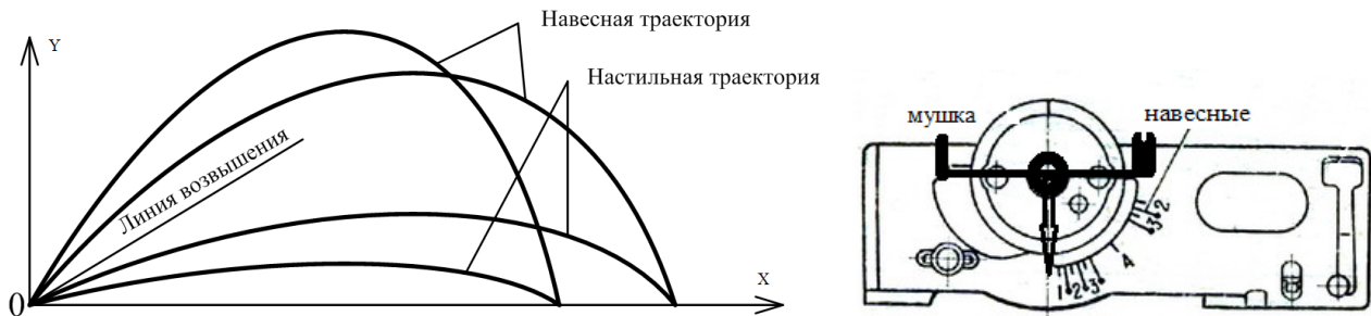
Рис. 1. Настильные и навесные траектории ГП-25 и схема прицела Fig. 1. Floor and hinged trajectories of GP-25 and sight diagram
