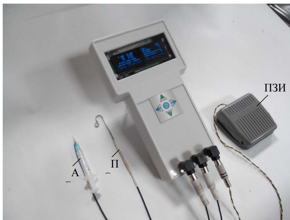
Рис. 4. Внешний вид ИЭУ: АЭ – активный электрод; ПЭ – пассивный электрод; ПЗИ – педаль запуска измерений
