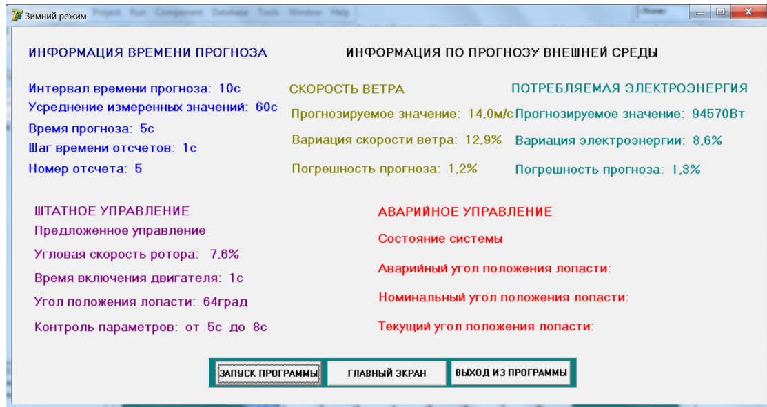
Рис. 5. Программный модуль управления работой ветроагрегата в условиях зимнего периода
