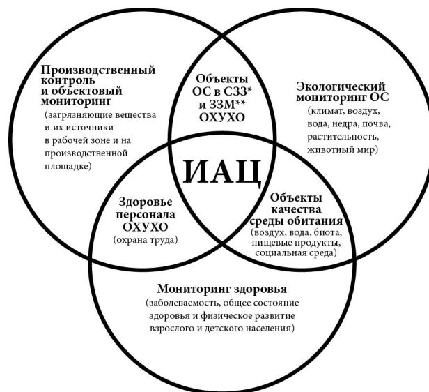
Рис. 1. Схема взаимодействия систем в рамках КЭМ ОХУХО (по Т. Я. Ашихминой) * – санитарно-защитная зона, ** – зона защитных мероприятий
