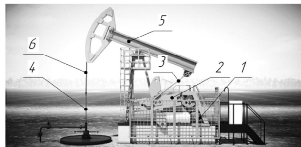
Рис. 1. Станок-качалка: 1 – электродвигатель, 2 – кривошип, 3 – шатун, 4 – полированный шток, 5 – балансир, 6 – канатная подвеска
