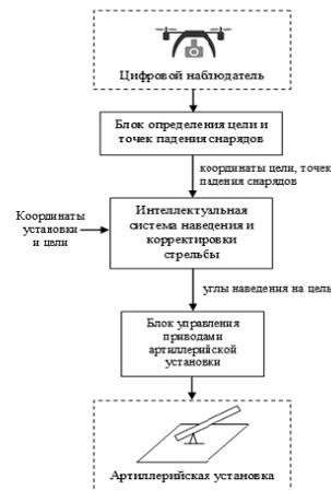
Рис. 2. Структурная схема системы наведения и корректировки стрельбы
