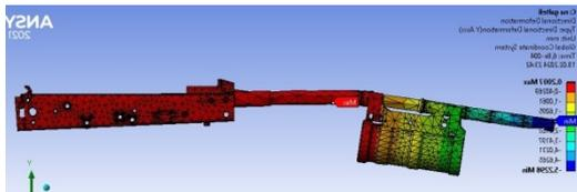
Рис. 16. Перемещения по оси  $Y$  при приложении нагрузки на дно канала ствола подствольного гранатомета
