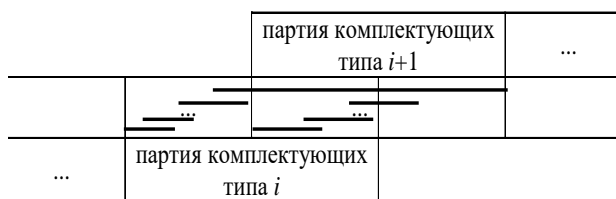
Рис. 3. Измененная схема последовательности изготовления комплектующих
