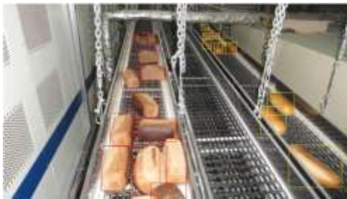
Рис. 5. Разметка хлеба на конвейере при помощи интеллектуальной системы
