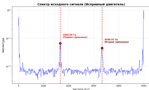
Рис. 3. Спектр исходного сигнала (класс «Исправный»)
