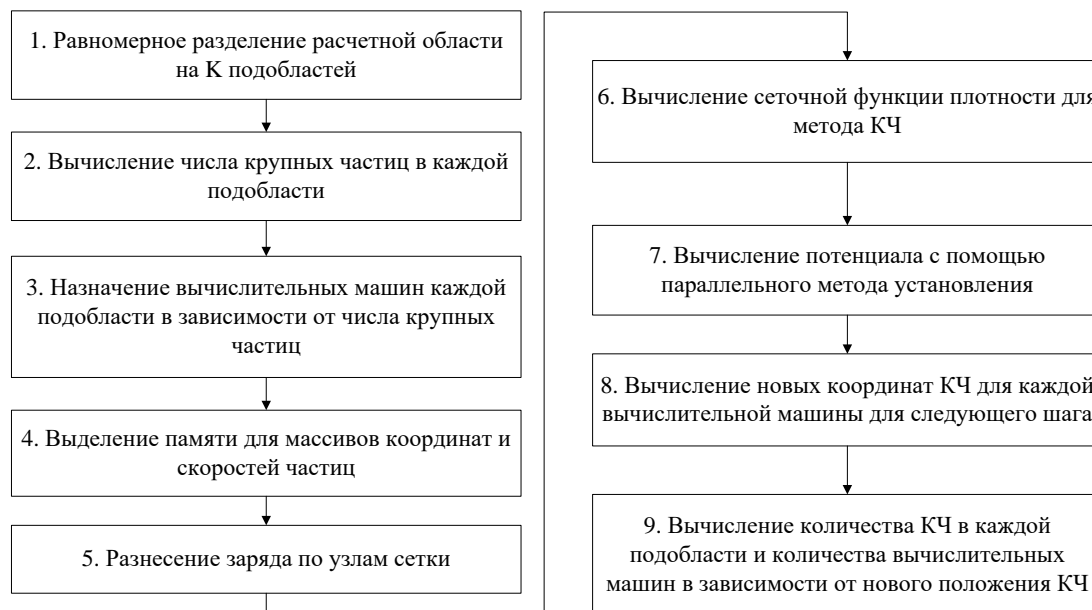
Рис. 3. Схема динамической балансировки нагрузки процессоров вычислительного кластера
