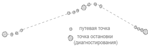
Рис. 1. Финальная траектория движения робототехнического комплекса с учетом ограничений по радиусу поворота
