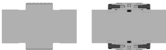
Рис. 9. Варианты поршней: с лабиринтным (слева) и герметичным (справа) уплотнениями
