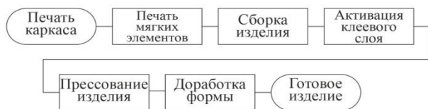
Рис. 5. Маршрут изготовления индивидуальной ортопедической стельки
