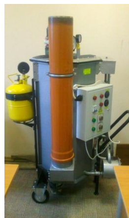
Рис. 1. Экспериментальная биогазовая установка
