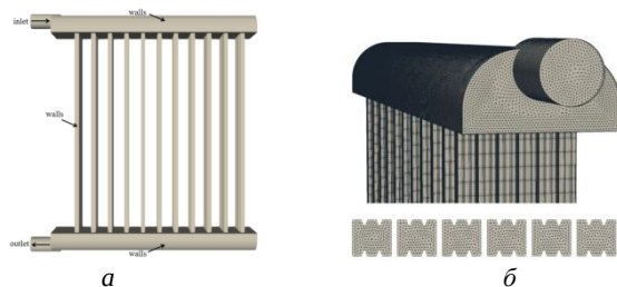
Рис. 4. Исследуемый в работе теплообменный аппарат: а – геометрическая модель; б – фрагменты расчетной сетки
